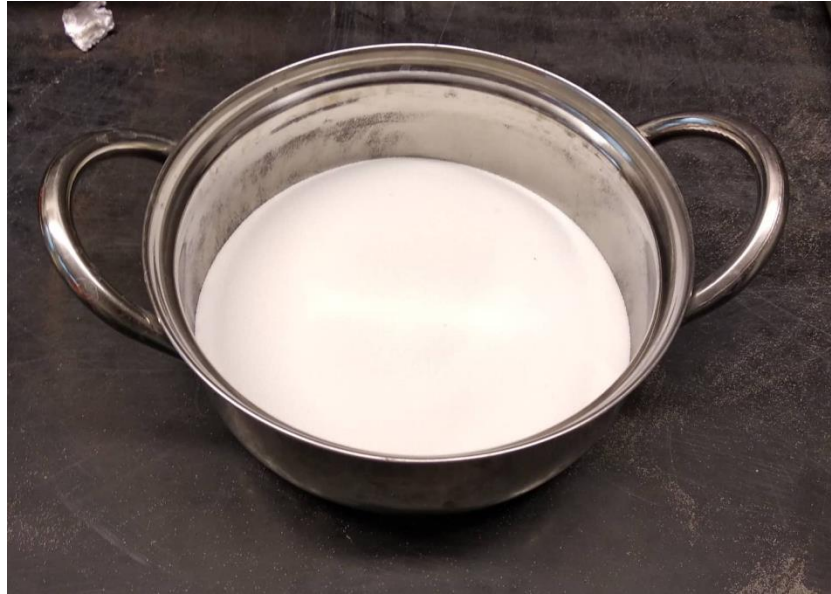
18. ábra: A por reológiai mérésekhez használt zirkon-oxid minta (szerző saját szerkesztése)
