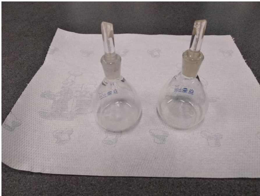
19. ábra: A mérésekhez használt üveg piknométerek (szerző saját szerkesztése)
