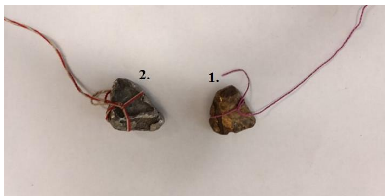
30. ábra: A süllyedési kísérletekhez használt réz és alumínium szemcsék (szerző saját szerkesztése)
