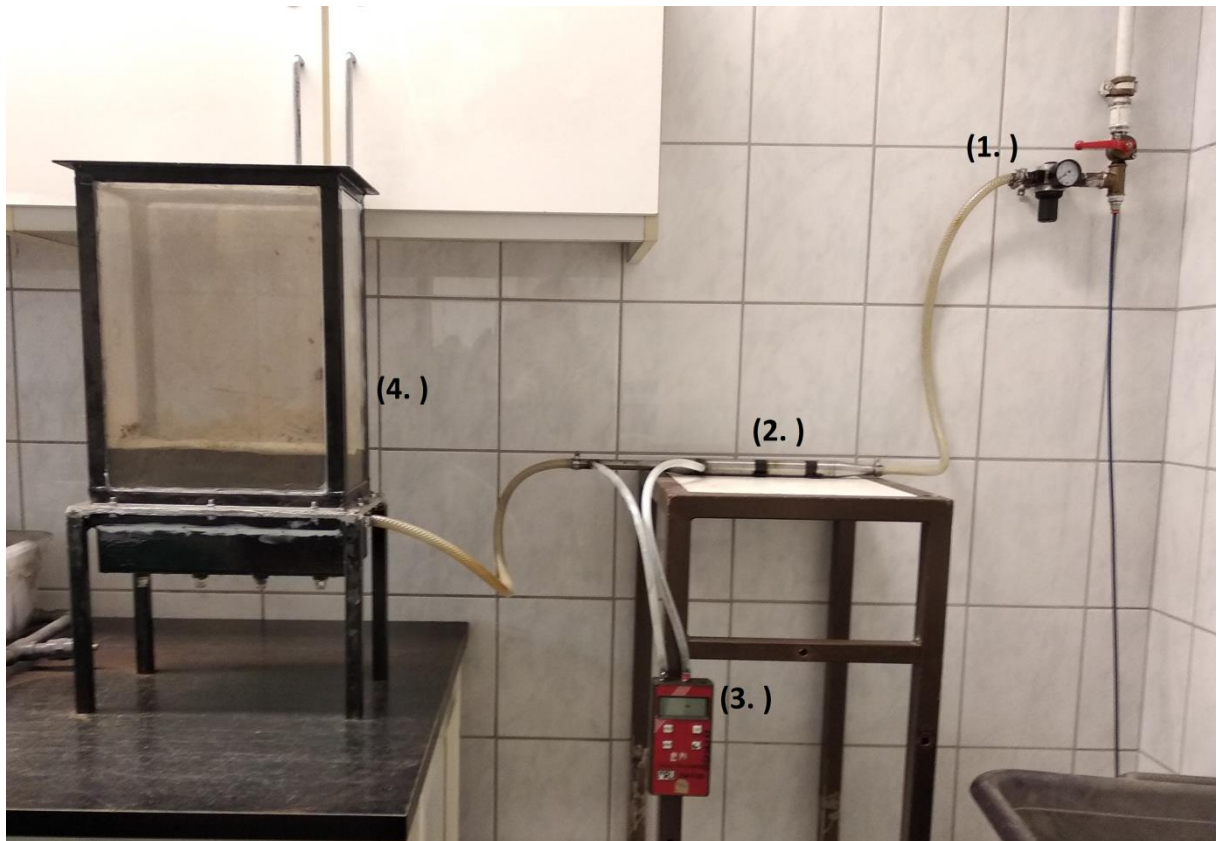
27. ábra: A mérőkör és fluidizációs kamra (szerző saját szerkesztése)
