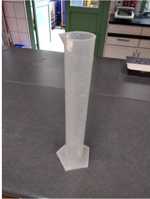
20. ábra: A halmazsűrűség meghatározásához használt mérőhenger (szerző saját szerkesztése)
