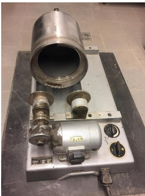
32. ábra: Forgó dobként működő micro-Deval malom (szerző saját szerkesztése)
