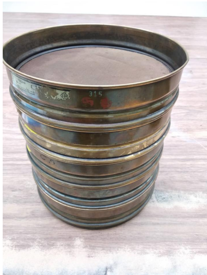
22. ábra: A szitaelemzéshez használt szitator (szerző saját szerkesztése)
